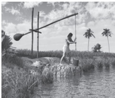
Η τεχνική του Shaduf βασίζεται στην ανύψωση του νερού από το κανάλι μέσω ενός μοχλού με αντίβαρο. Πηγή: Wayne School of Engineering.
