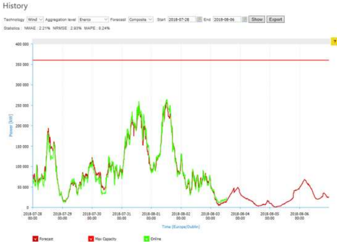
Σχήμα 4: Ενδεικτική πρόγνωση παραγωγής και σύγκριση με τη πραγματικότητα για αιολικό πάρκο.
